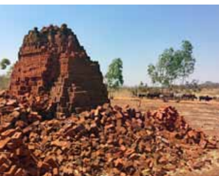
Ziegelbrennerei in der Steppe Um Ziegel für den Bau zu brennen, werden sie aus Lehm geformt und dann mit einem Feuer in der Mitte der Ofen-Vorrichtung gebrannt.
